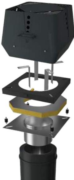
Bei der Montage des Rauchsaugers auf einem Edelstahl Schornstein oder Rohr-element mit einem Montageflansch (separat zu bestellen), kommen die Gummischwingungsdämpfer SVD-RS bzw. FR4(separat zu bestellen) mit beidseitigem Gewinde zum Einsatz.
