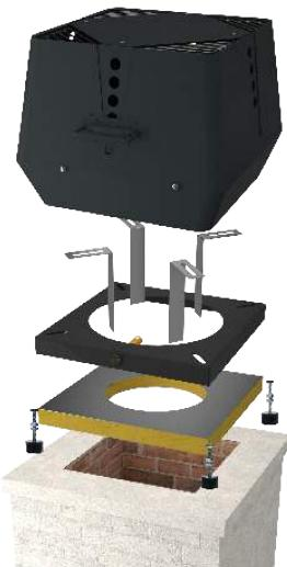
Bei der Montage des Rauchsaugers auf einem gemauerten Schornstein mit Abdeckung FRXXXAFD6-001 (separat zu bestellen) zum Schutz der Schalldämmplatte, werden die Gummischwingungsdämpfer RSD (separat zu bestellen) als Abstandshalter mit eingebaut.
